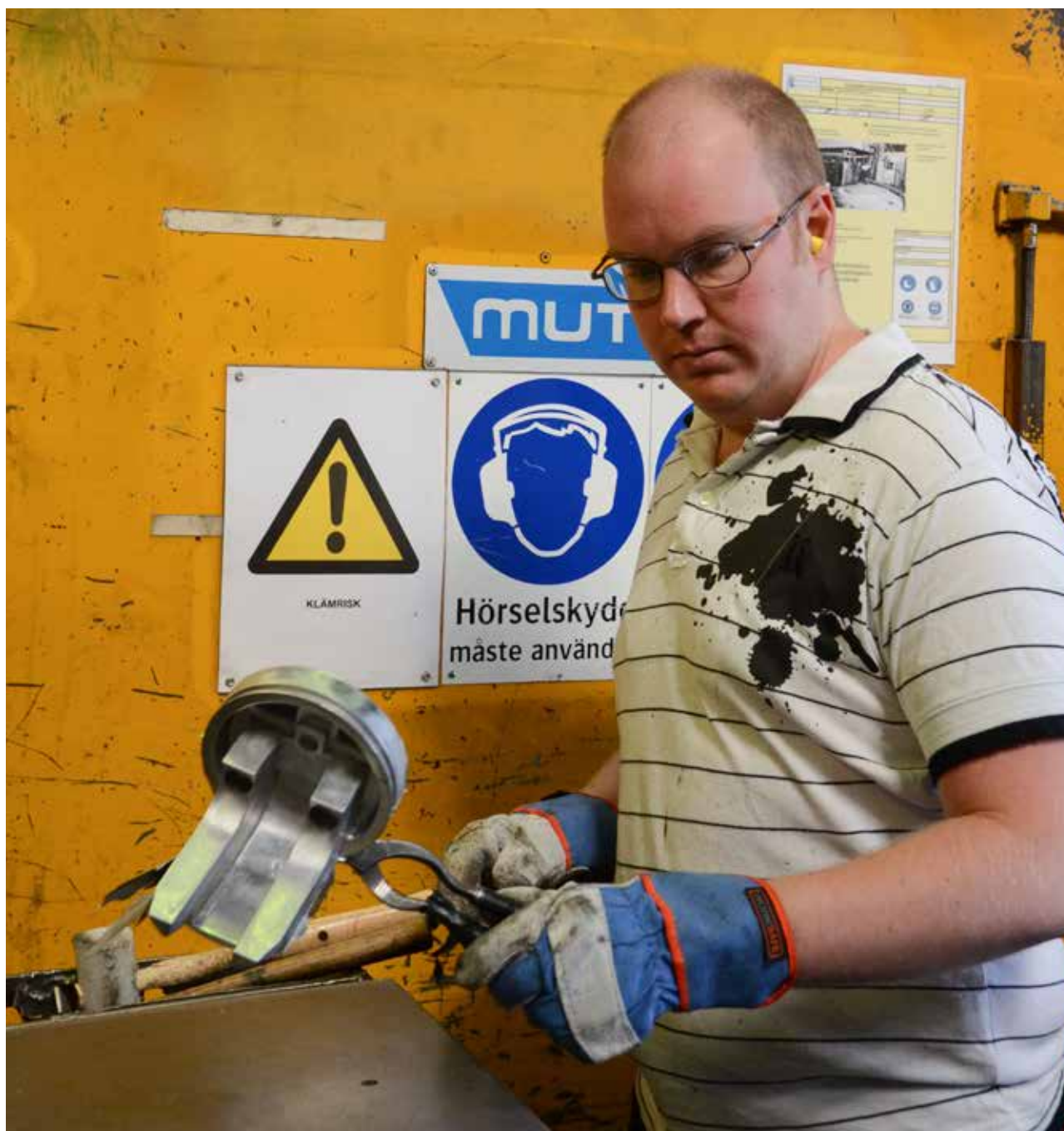
Vid en av bolagets pressgjutmaskiner står Simon Olofsson och slår bort ingjutsystem.
