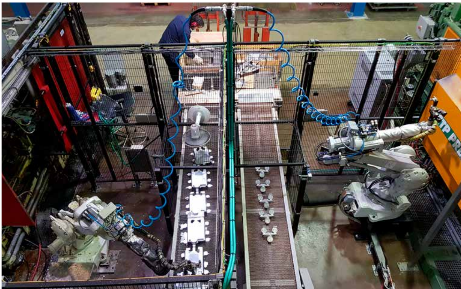
En av Blekinge Pressgjuteris senaste investeringar är två nya automatiserade gjutceller som hanteras av en operatör.
