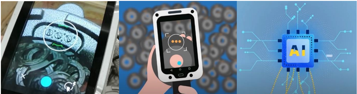
Figur 3.14. DISA TAG systemet skapar en länk mellan processdata och kvalitetsresultat hos gjuteriets sandformar i tre steg 101
