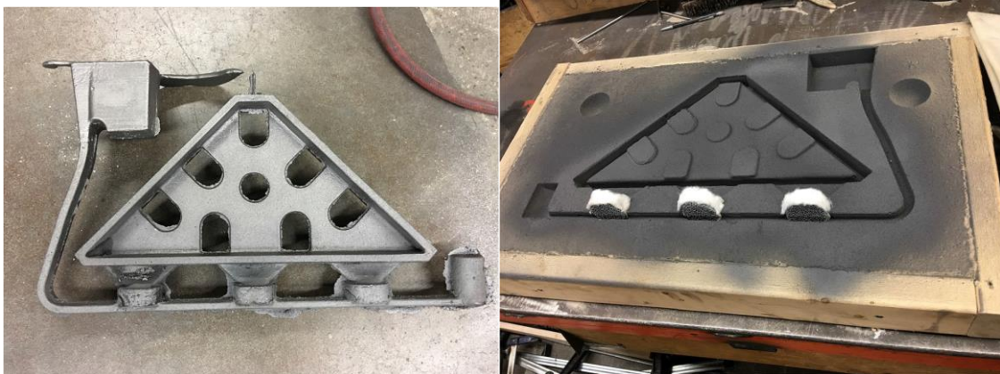
Figur 3.10. Naturligt trycksatt flödesoptimerat ingjutsystem för segjärn.
