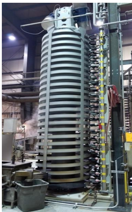
Figur 4 Vattenkyld vibrerande spiraltransportör. Källa: Vibra Schultheis
